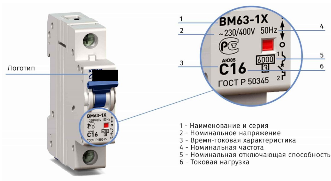
Рисунок 2. Пример маркировки АВ
